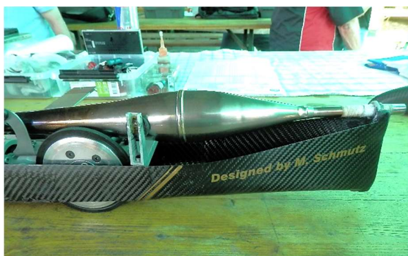
Gleiches Modell, Auspuff als Resonanzrohr
